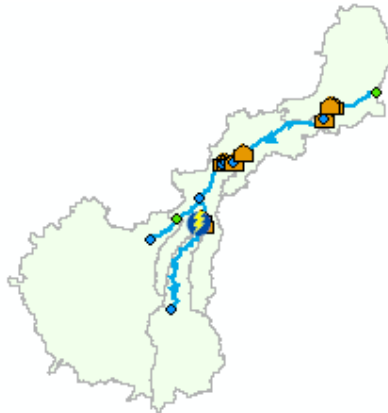
Figure 0-1 : Représentation du barrage de Sélingué et du bassin versant associé issu du modèle MIKE BASIN du Niger
